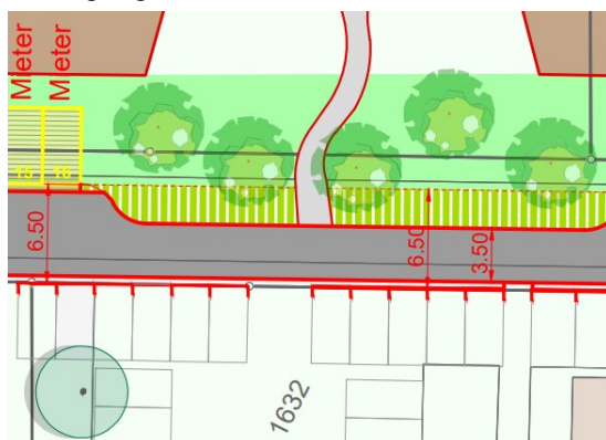
Abbildung 12: Planausschnitt Situation Fahrbahneinengung
