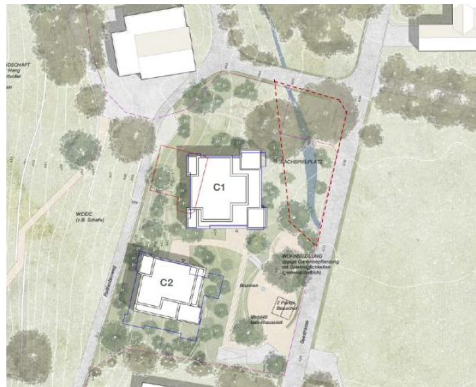
Abbildung 12: Freizuhaltender Bereich für die Ausdolung des Althusbachs
