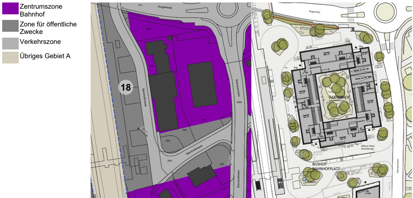
Abbildung 2: Vergleich rechtskräftige Zonierung (links) und Strassenbauprojekt (rechts)
