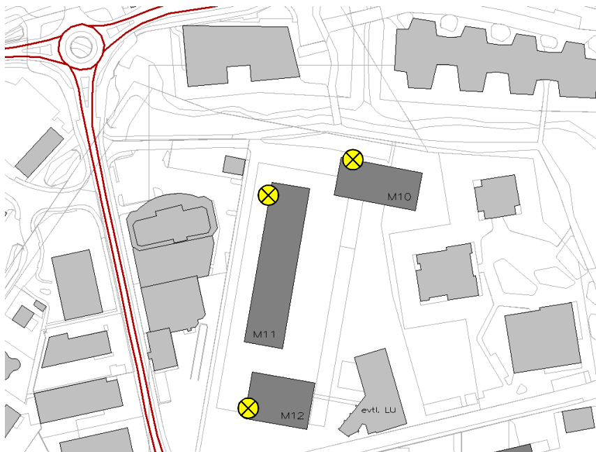
Abbildung 6: Lage Empfangspunkt Berechnung Strassenlärm
