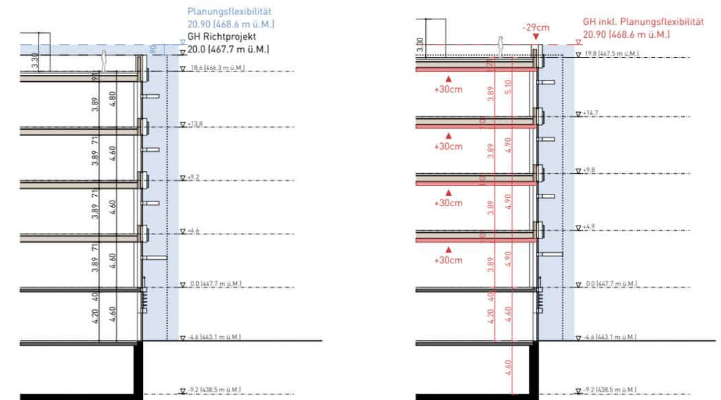
Abb.9 Herleitung maximale Gebäudehöhe Kopfbau Nord
