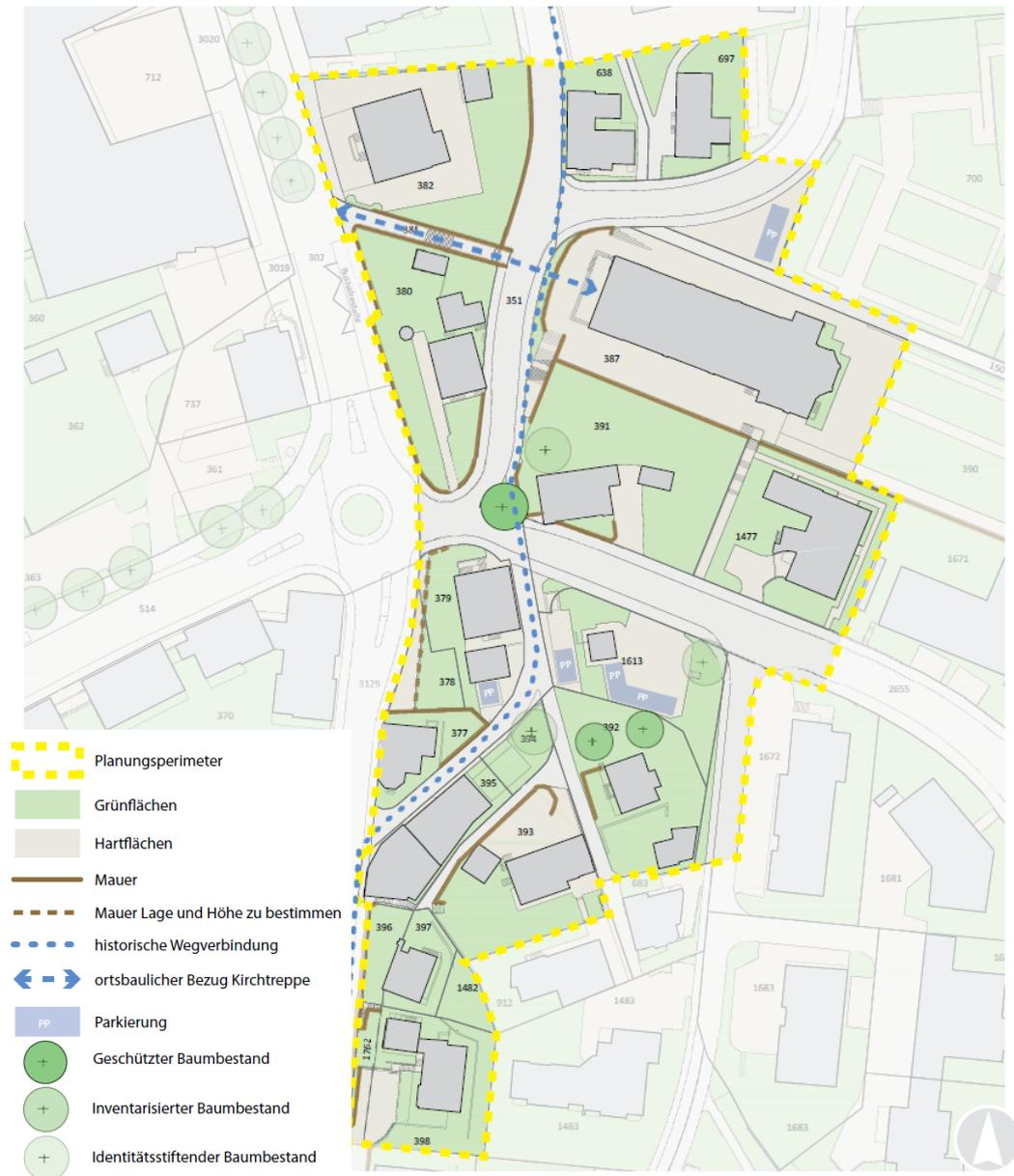
Abbildung 11: Plan der Analyse des Aussenraums
