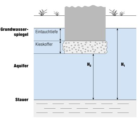
**Bedingung:**  $0.9 \cdot H_1 \cdot k_1 = H_2 \cdot k_1 + \text{Mächtigkeit Kieskoffer} \cdot \text{k-Wert Kieskoffer};$
