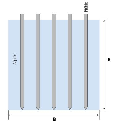
**Annahme:** es werden 5 Pfähle erstellt; r = 20 cm: die Einbusse an durchströmter Fläche beträgt 20%; die GSchV wird somit im vorliegenden Beispiel nicht erfüllt.
