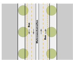
Querschnitt/Grundriss Südallee | 1:500
